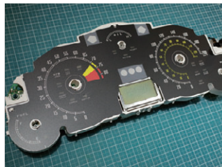
2-6: ゲージパネルの装着 ゲージパネルをセットします。
