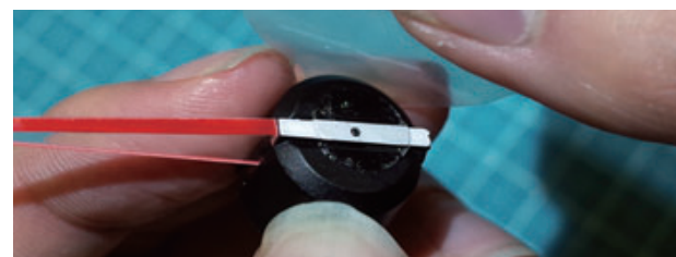
③ 剥離フィルムをゆっくりと剥がし、キャップを被せて固定します。指針小(3ヶ)も大指針と同じ要領でゲルシールを使用してキャップを被せて固定します。この後、2-8の工程に戻して下さい。
