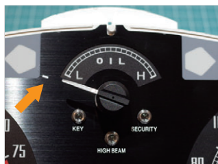
2-9: 指針の再装着② 同様に小メーター3箇所についても再装着します。この3つはゼロ位置よりマイナス方向にあるデフォルト位置(純正表示盤同様にデザインパネルにもデフォルトマークを付けています)を指すように仮差しし、デフォルト位置よりもマイナス方向に動かないことを確認して奥まで差し込みます(調整時、水温計のみ時計回り)。
