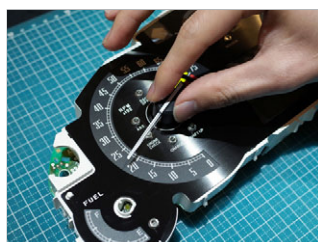
2-8: 指針の再装着① 速度計と回転計に指針を再装着します。ゼロ位置に指針の先を合わせて差し込みます。仮差し状態でゼロよりマイナス方向に動かないか確認します。もし動く場合2-2の作業と同様、反時計回りに回転させてゼロ位置で止まるよう調整します。位置が決まれば奥まで差し込みますが、パネルに触れるまで差し込まないで数ミリのクリアランス(隙間)をキープして下さい。
