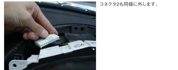
熱線作動灯コネクタを外します。 熱線作動灯コネクタは、スポンジの中に コネクタ離脱用爪があります。
