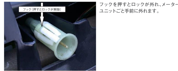
運転席からは直接見えない部分なので 手探りの作業となりますが、構造が理解 できていれば簡単に着脱可能です。
