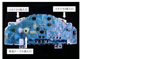
3-1: アクリルカバーの取り外し メーターの透明アクリルカバーを開け、 表示盤を交換します。指紋等汚れの付着 を防止するため、一度きれいに手を洗って おくとよいでしょう。 透明アクリルカバーを留めている爪を マイナスドライバーで押さえ、ユニット 本体から取り外します。
