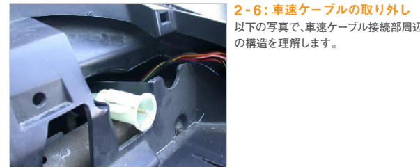
フック(押すとロックが解除) フックを押すとロックが外れ、メーター ユニットごと手前に外れます。
